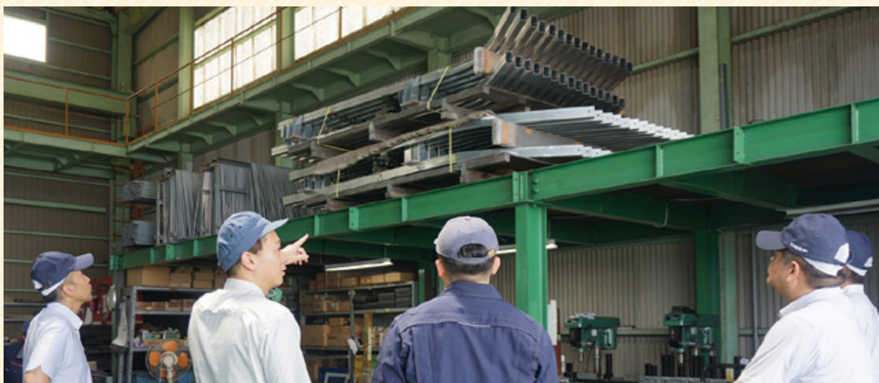
特殊金型で加工した牽引トレーラーの部材(写真上部)
